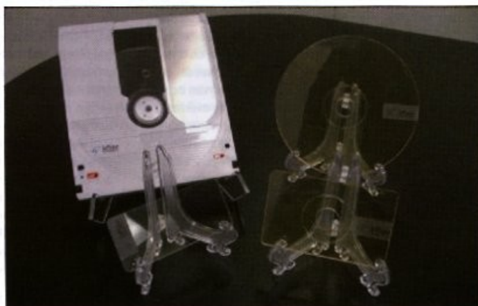
Tapestry: het holografische opslagmedium van InPhase.
