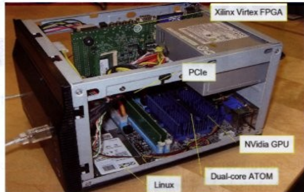
Figuur 3. Een voorbeeld van een embedded systeem dat met behulp van vfAnalyst is ontworpen en geoptimaliseerd.
